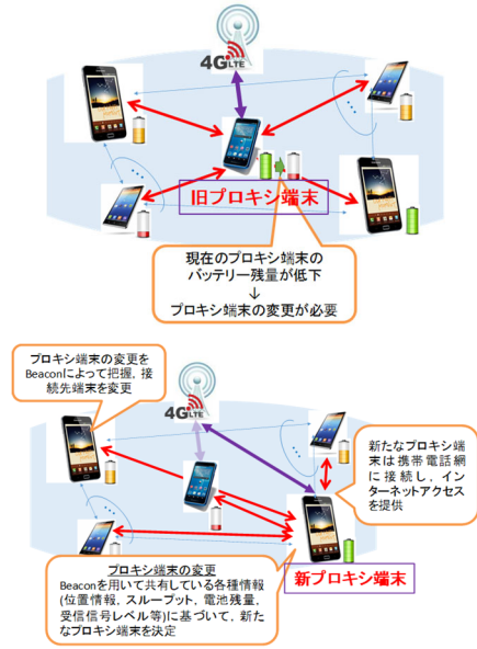
図2 バッテリー低下時のプロキシ端末の変更例 Figure 2 Proxy Changing Depending on a Low-Battery Power.
