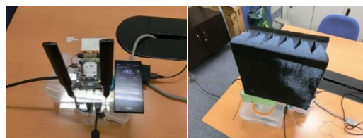
図 3 通信電力効率測定用テストベッドおよび電波吸収体を用いた実験風景
