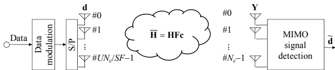
図 2 マルチコード DS-CDMA 伝送と等価な N_c \times UN_c / SF MIMO チャンネル
